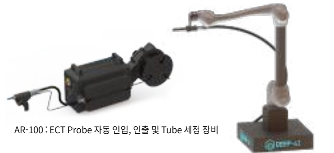
AIROBO-100 : Computer Vision 기반의 ECT 자동 검사 로봇
