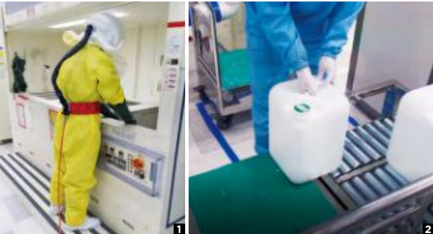
1 작업발판 미끄럼 방지 및 작업공간 확대 2 레일밀차의 사용으로 운반 시 물리적 힘 최소화 3 위험성평가 관리자 회의 모습 4 제작한 운반 및 보관용 레일 밀차
