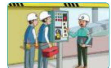
3 기동장치 잠금조치, 작동금지 표지판 설치
