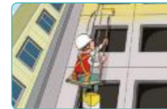
5 달비계 작업 시 안전대 착용 및 구명줄 설치
